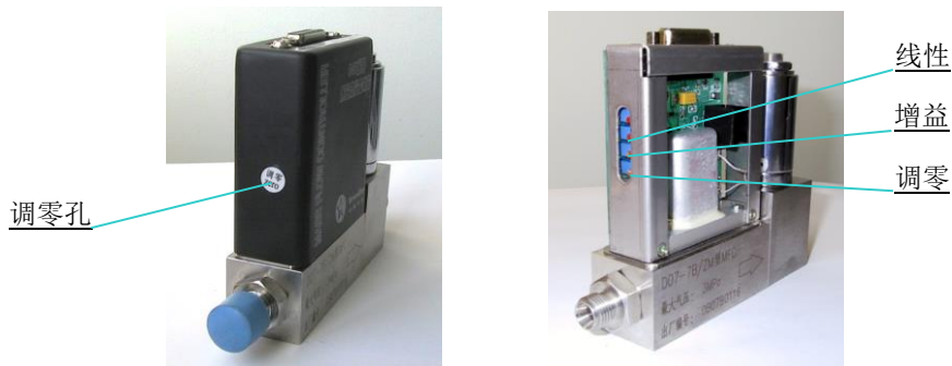
图 9. 7B 型调节电位器位置图
