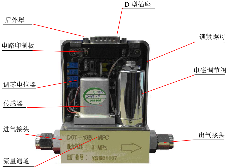
图 2. 质量流量控制器结构图
