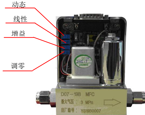
图 14. D07-19B、D07-19BM 型调零电位器位置图
