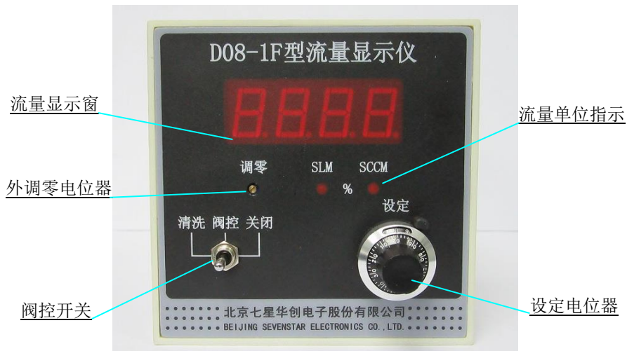
图 15. 流量显示仪操作面板
